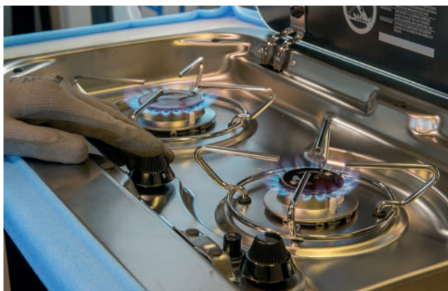
Test sul funzionamento delle condutture del gas.
