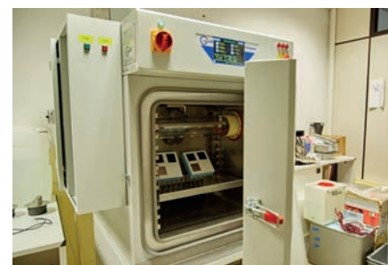
Test prestazionali sulla componentistica impiegata. Durabilità dei materiali, resistenza alle sollecitazioni, affidabilità e conformità alla regolamentazione europea nella progettazione del blocco delle cinture di sicurezza.
